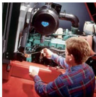
La inspección diaria es sencilla y puede realizarse desde el nivel del suelo.
